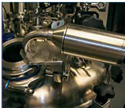
PURE VIEW™ sanitární světelný zdroj a průzorové okno
